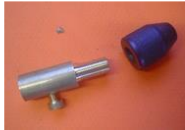
Les dimensions dépendront du mandrin récupéré (ici un mandrin avec filetage de 8 x 0.75).
