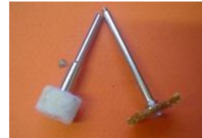
Pratique pour utiliser des accessoires du commerce comme des tampons de feutre ou encore une brosse métallique en laiton.
