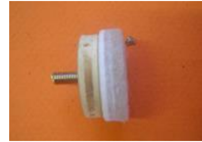
La rondelle de feutre est appliquée et ... ça tient ! Facilité de remplacement ...
