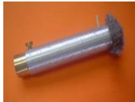
Les dimensions dépendront du mandrin récupéré (ici un mandrin avec filetage de 8 x 0.75).
