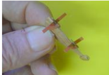
gouvernail: pentures en carton autour de l'axe (aiguille)
