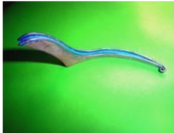
Un dauphin ou jottereau avec l'allège obtenu par "moulage" .
